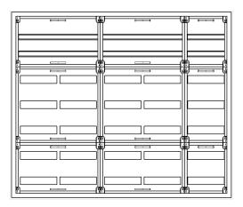
AVK5-7-230-SAutomatenverteiler, AVK, BxHxT = 1300x1100x230Schutzklasse II, IP54, RAL 7035, AufputzBestehend aus:Gehäuse, Doppeltür mit Schwenkhebel für PHZ, Flansche SF45 (oben) und SF41 (unten), 2x Geräteträger 2-Feld breit 2/5 mit Feldabdeckungen PRL, 1x Geräteträger 1-Feld breit 2/5 mit Feldabdeckungen PRL
