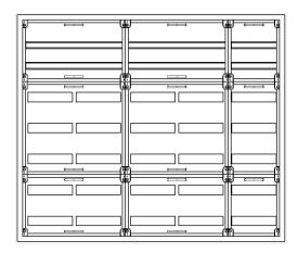
AVK5-7-230-S-PAutomatenverteiler, AVK, BxHxT = 1300x1100x230Schutzklasse II, IP54, RAL 7035, AufputzBestehend aus:Gehäuse, Doppeltür mit Schwenkhebel für PHZ, Flansche SF45 (oben) und SF41 (unten), 2x Geräteträger 2-Feld breit 2/5 mit Feldabdeckungen PS, 1x Geräteträger 1-Feld breit 2/5 mit Feldabdeckungen PS
