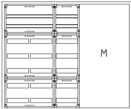
AVK5-7-230-M2-PAutomatenverteiler, AVK, BxHxT = 1300x1100x230Schutzklasse II, IP54, RAL 7035, AufputzBestehend aus:Gehäuse, Doppeltür mit Schwenkhebel für PHZ, Flansche SF45(oben) und SF41 (unten), 1x Geräteträger 2-Feld breit 2/5 mit Feldabdeckungen PS, 1x Geräteträger 1-Feld breit 2/5 mit Feldabdeckungen PS, 1x Montageplatte 2-Feld breit
