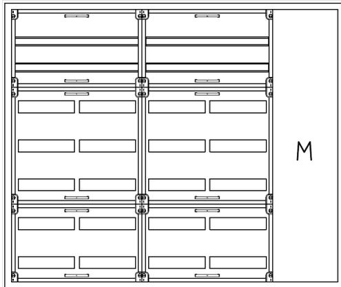
AVK5-7-230-M1 Automatenverteiler, AVK, BxHxT = 1300x1100x230 Schutzklasse II, IP54, RAL 7035, Aufputz
