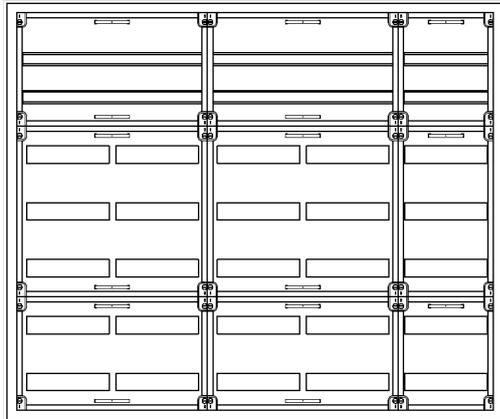
AVK5-7-210-S Automatenverteiler, AVK, BxHxT = 1300x1100x210 Schutzklasse II, IP41, RAL 9016, Aufputz
