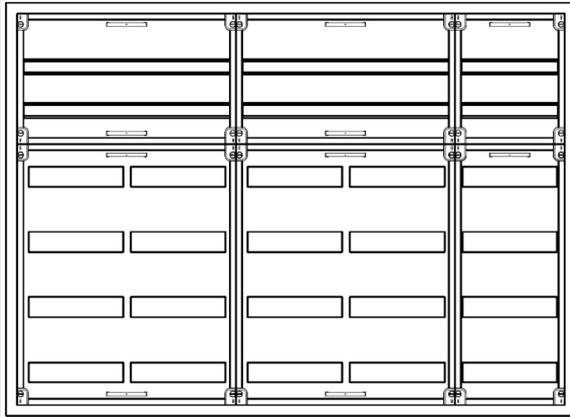
AVK5-6-230-S-PAutomatenverteiler, AVK, BxHxT = 1300x950x230Schutzklasse II, IP54, RAL 7035, AufputzBestehend aus:Gehäuse, Doppeltür mit Schwenkhebel für PHZ, Flansche SF45 (oben) und SF41 (unten), 2x Geräteträger 2-Feld breit 2/4 mit Feldabdeckungen PS, 1x Geräteträger 1-Feld breit 2/4 mit Feldabdeckungen PS
