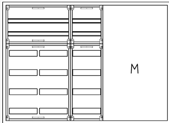
AVK5-6-230-M2-PAutomatenverteiler, AVK, BxHxT = 1300x950x230Schutzklasse II, IP54, RAL 7035, AufputzBestehend aus:Gehäuse, Doppeltür mit Schwenkhebel für PHZ, Flansche SF45(oben) und SF41 (unten), 1x Geräteträger 2-Feld breit 2/4 mit Feldabdeckungen PS, 1x Geräteträger 1-Feld breit 2/4 mit Feldabdeckungen PS, 1x Montageplatte 2-Feld breit
