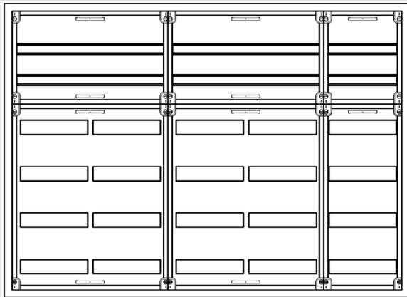
AVK5-6-210-S-PAutomatenverteiler, AVK, BxHxT = 1300x950x210 Schutzklasse II, IP41, RAL 9016, Aufputz
