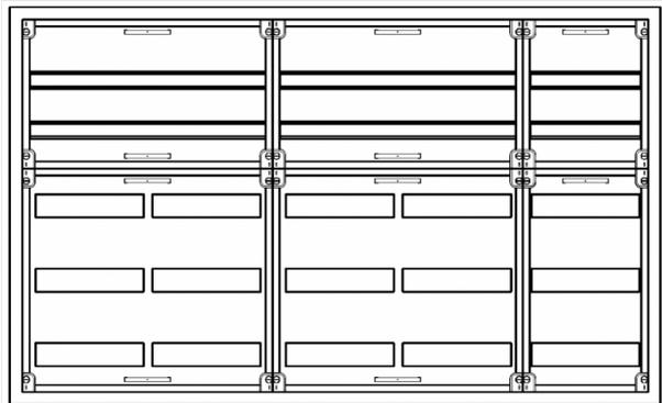
AVK5-5-230-S Automatenverteiler, AVK, BxHxT = 1300x800x230 Schutzklasse II, IP54, RAL 7035, Aufputz
