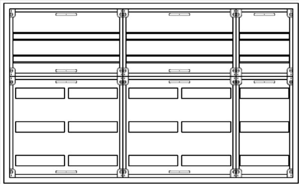
AVK5-5-230-S-PAutomatenverteiler, AVK, BxHxT = 1300x800x230 Schutzklasse II, IP54, RAL 7035, Aufputz Bestehend aus: Gehäuse, Doppeltür mit Schwenkhebel für PHZ, Flansche SF45 (oben) und SF41 (unten), 2x Geräteträger 2-Feld breit 2/3 mit Feldabdeckungen PS, 1x Geräteträger 1-Feld breit 2/3 mit Feldabdeckungen PS
