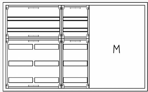
AVK5-5-230-M2 Automatenverteiler, AVK, BxHxT = 1300x800x230 Schutzklasse II, IP54, RAL 7035, Aufputz
