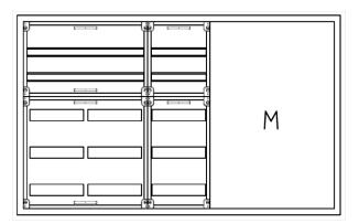
AVK5-5-230-M2-PAutomatenverteiler, AVK, BxHxT = 1300x800x230Schutzklasse II, IP54, RAL 7035, AufputzBestehend aus:Gehäuse, Doppeltür mit Schwenkhebel für PHZ, Flansche SF45(oben) und SF41 (unten), 1x Geräteträger 2-Feld breit 2/3 mit Feldabdeckungen PS, 1x Geräteträger 1-Feld breit 2/3 mit Feldabdeckungen PS, 1x Montageplatte 2-Feld breit
