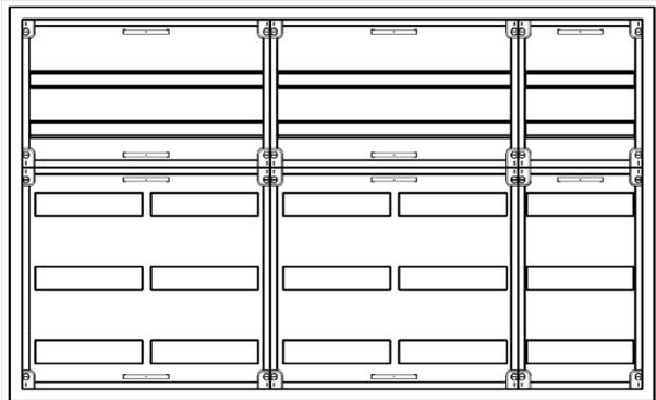
AVK5-5-210-S Automatenverteiler, AVK, BxHxT = 1300x800x210 Schutzklasse II, IP41, RAL 9016, Aufputz
