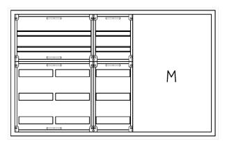
AVK5-5-210-M2-PAutomatenverteiler, AVK, BxHxT = 1300x800x210Schutzklasse II, IP41, RAL 9016, AufputzBestehend aus:Gehäuse, Doppeltür mit Drehriegel, Flansche NF1(oben) und NF2 (unten), 1x Geräteträger 2-Feld breit 2/3 mit Feldabdeckungen PS, 1x Geräteträger 1-Feld breit 2/3 mit Feldabdeckungen PS, 1x Montageplatte 2-Feld breit
