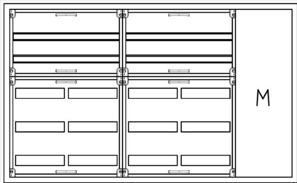
AVK5-5-210-M1 Automatenverteiler, AVK, BxHxT = 1300x800x210 Schutzklasse II, IP41, RAL 9016, Aufputz
