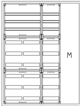
AVK4-9-230-M1 Automatenverteiler, AVK, BxHxT = 1050x1400x230 Schutzklasse II, IP54, RAL 7035, Aufputz
