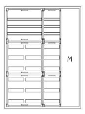
AVK4-9-230-M1-PAutomatenverteiler, AVK, BxHxT = 1050x1400x230Schutzklasse II, IP54, RAL 7035, AufputzBestehend aus:Gehäuse, Doppeltür mit Schwenkhebel für PHZ, Flansche SF45(oben) und SF41 (unten), 1x Geräteträger 2-Feld breit 3/6 mit Feldabdeckungen PS, 1x Geräteträger 1-Feld breit 3/6 mit Feldabdeckungen PS, 1x Montageplatte 1-Feld breit
