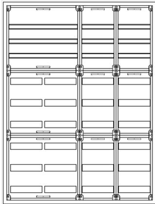
AVK4-9-210-S-PAutomatenverteiler, AVK, BxHxT = 1050x1400x210 Schutzklasse II, IP41, RAL 9016, Aufputz
