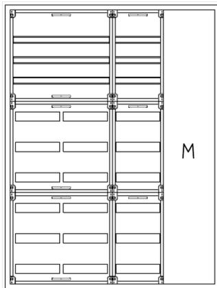
AVK4-9-210-M1-PAutomatenverteiler, AVK, BxHxT = 1050x1400x210Schutzklasse II, IP41, RAL 9016, AufputzBestehend aus:Gehäuse, Doppeltür mit Drehriegel, Flansche NF1(oben) und NF2 (unten), 1x Geräteträger 2-Feld breit 3/6 mit Feldabdeckungen PS, 1x Geräteträger 1-Feld breit 3/6 mit Feldabdeckungen PS, 1x Montageplatte 1-Feld breit
