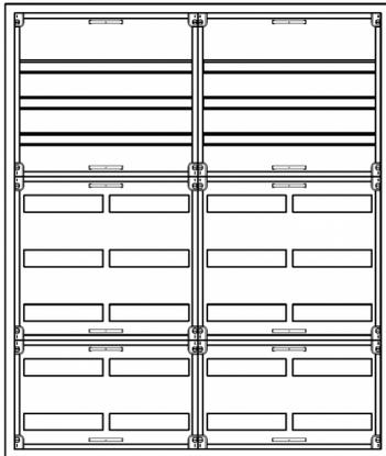
AVK4-8-230 Automatenverteiler, AVK, BxHxT = 1050x1250x230 Schutzklasse II, IP54, RAL 7035, Aufputz
