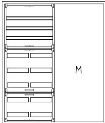
AVK4-8-230-M2 Automatenverteiler, AVK, BxHxT = 1050x1250x230 Schutzklasse II, IP54, RAL 7035, Aufputz
