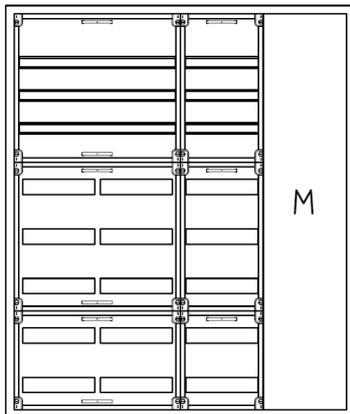
AVK4-8-230-M1 Automatenverteiler, AVK, BxHxT = 1050x1250x230 Schutzklasse II, IP54, RAL 7035, Aufputz
