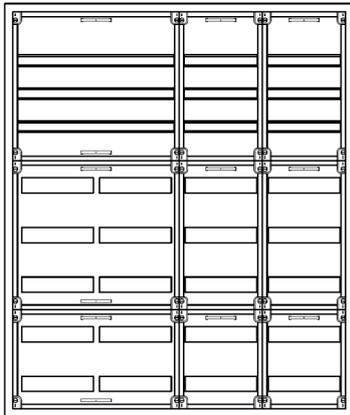
AVK4-8-210-S Automatenverteiler, AVK, BxHxT = 1050x1250x210 Schutzklasse II, IP41, RAL 9016, Aufputz
