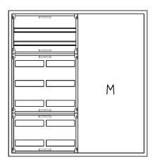
AVK4-7-230-M2Automatenverteiler, AVK, BxHxT = 1050x1100x230Schutzklasse II, IP54, RAL 7035, AufputzBestehend aus:Gehäuse, Doppeltür mit Schwenkhebel für PHZ, Flansche SF45(oben) und SF41 (unten), 1x Geräteträger 2-Feld breit 2/5 mit Feldabdeckungen PRL, 1x Montageplatte 2-Feld breit
