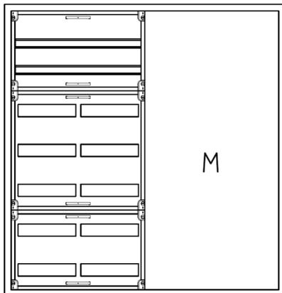
AVK4-7-230-M2-PAutomatenverteiler, AVK, BxHxT = 1050x1100x230Schutzklasse II, IP54, RAL 7035, AufputzBestehend aus:Gehäuse, Doppeltür mit Schwenkhebel für PHZ, Flansche SF45(oben) und SF41 (unten), 1x Geräteträger 2-Feld breit 2/5 mit Feldabdeckungen PS, 1x Montageplatte 2-Feld breit
