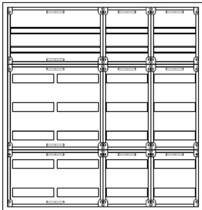
AVK4-7-210-S-PAutomatenverteiler, AVK, BxHxT = 1050x1100x210 Schutzklasse II, IP41, RAL 9016, Aufputz
