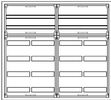
AVK4-6-230-PAutomatenverteiler, AVK, BxHxT = 1050x950x230 Schutzklasse II, IP54, RAL 7035, Aufputz
