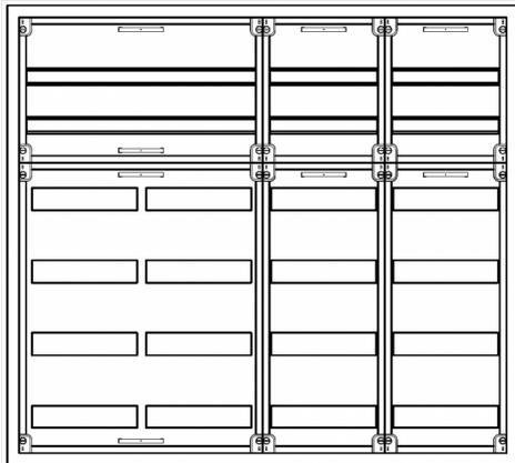
AVK4-6-210-S Automatenverteiler, AVK, BxHxT = 1050x950x210 Schutzklasse II, IP41, RAL 9016, Aufputz
