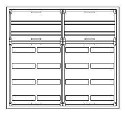
AVK4-6-210-PAutomatenverteiler, AVK, BxHxT = 1050x950x210Schutzklasse II, IP41, RAL 9016, AufputzBestehend aus:Gehäuse, Doppeltür mit Drehriegel, Flansche NF1 (oben) und NF2 (unten), 2x Geräteträger 2-Feld breit 2/4 mit Feldabdeckungen PS
