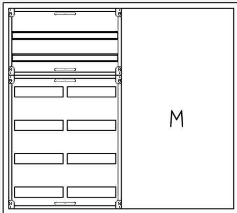
AVK4-6-210-M2-PAutomatenverteiler, AVK, BxHxT = 1050x950x210 Schutzklasse II, IP41, RAL 9016, Aufputz
