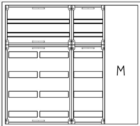
AVK4-6-210-M1-PAutomatenverteiler, AVK, BxHxT = 1050x950x210Schutzklasse II, IP41, RAL 9016, AufputzBestehend aus:Gehäuse, Doppeltür mit Drehriegel, Flansche NF1(oben) und NF2 (unten), 1x Geräteträger 2-Feld breit 2/4 mit Feldabdeckungen PS, 1x Geräteträger 1-Feld breit 2/4 mit Feldabdeckungen PS, 1x Montageplatte 1-Feld breit
