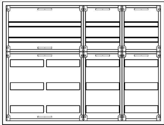
AVK4-5-230-S Automatenverteiler, AVK, BxHxT = 1050x800x230 Schutzklasse II, IP54, RAL 7035, Aufputz
