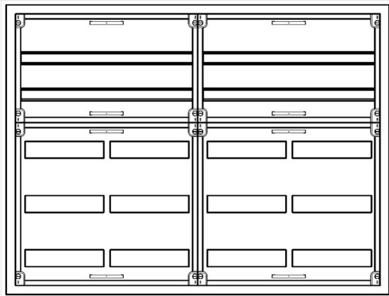
AVK4-5-230-PAutomatenverteiler, AVK, BxHxT = 1050x800x230Schutzklasse II, IP54, RAL 7035, AufputzBestehend aus:Gehäuse, Doppeltür mit Schwenkhebel für PHZ, Flansche SF45 (oben) und SF41 (unten), 2x Geräteträger 2-Feld breit 2/3 mit Feldabdeckungen PS
