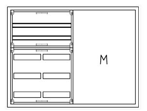
AVK4-5-230-M2Automatenverteiler, AVK, BxHxT = 1050x800x230Schutzklasse II, IP54, RAL 7035, AufputzBestehend aus:Gehäuse, Doppeltür mit Schwenkhebel für PHZ, Flansche SF45(oben) und SF41 (unten), 1x Geräteträger 2-Feld breit 2/3 mit Feldabdeckungen PRL, 1x Montageplatte 2-Feld breit
