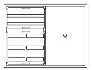
AVK4-5-230-M2-PAutomatenverteiler, AVK, BxHxT = 1050x800x230Schutzklasse II, IP54, RAL 7035, AufputzBestehend aus:Gehäuse, Doppeltür mit Schwenkhebel für PHZ, Flansche SF45(oben) und SF41 (unten), 1x Geräteträger 2-Feld breit 2/3 mit Feldabdeckungen PS, 1x Montageplatte 2-Feld breit
