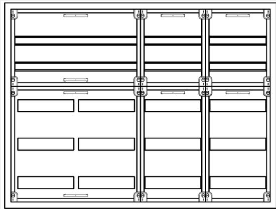
AVK4-5-210-S-PAutomatenverteiler, AVK, BxHxT = 1050x800x210Schutzklasse II, IP41, RAL 9016, AufputzBestehend aus:Gehäuse, Doppeltür mit Drehriegel, Flansche NF1 (oben) und NF2 (unten), 1x Geräteträger 2-Feld breit 2/3 mit Feldabdeckungen PS, 2x Geräteträger 1-Feld breit 2/3 mit Feldabdeckungen PS
