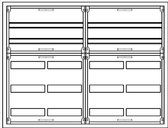
AVK4-5-210-PAutomatenverteiler, AVK, BxHxT = 1050x800x210Schutzklasse II, IP41, RAL 9016, AufputzBestehend aus:Gehäuse, Doppeltür mit Drehriegel, Flansche NF1 (oben) und NF2 (unten), 2x Geräteträger 2-Feld breit 2/3 mit Feldabdeckungen PS
