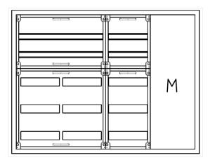
AVK4-5-210-M1-PAutomatenverteiler, AVK, BxHxT = 1050x800x210Schutzklasse II, IP41, RAL 9016, AufputzBestehend aus:Gehäuse, Doppeltür mit Drehriegel, Flansche NF1(oben) und NF2 (unten), 1x Geräteträger 2-Feld breit 2/3 mit Feldabdeckungen PS, 1x Geräteträger 1-Feld breit 2/3 mit Feldabdeckungen PS, 1x Montageplatte 1-Feld breit
