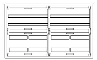
AVK4-4-230-PAutomatenverteiler, AVK, BxHxT = 1050x650x230Schutzklasse II, IP54, RAL 7035, AufputzBestehend aus:Gehäuse, Doppeltür mit Schwenkhebel für PHZ, Flansche SF45 (oben) und SF41 (unten), 2x Geräteträger 2-Feld breit 2/2 mit Feldabdeckungen PS
