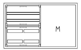
AVK4-4-230-M2Automatenverteiler, AVK, BxHxT = 1050x650x230Schutzklasse II, IP54, RAL 7035, AufputzBestehend aus:Gehäuse, Doppeltür mit Schwenkhebel für PHZ, Flansche SF45(oben) und SF41 (unten), 1x Geräteträger 2-Feld breit 2/2 mit Feldabdeckungen PRL, 1x Montageplatte 2-Feld breit
