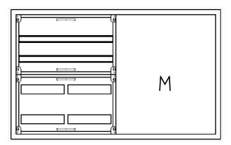
AVK4-4-230-M2-PAutomatenverteiler, AVK, BxHxT = 1050x650x230Schutzklasse II, IP54, RAL 7035, AufputzBestehend aus:Gehäuse, Doppeltür mit Schwenkhebel für PHZ, Flansche SF45(oben) und SF41 (unten), 1x Geräteträger 2-Feld breit 2/2 mit Feldabdeckungen PS, 1x Montageplatte 2-Feld breit
