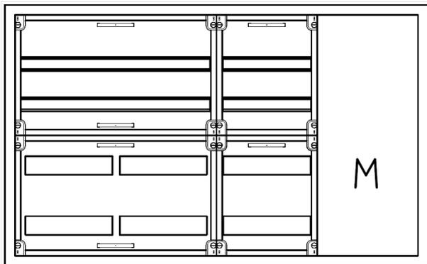
AVK4-4-230-M1 Automatenverteiler, AVK, BxHxT = 1050x650x230 Schutzklasse II, IP54, RAL 7035, Aufputz
