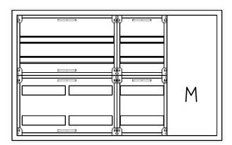
AVK4-4-230-M1-PAutomatenverteiler, AVK, BxHxT = 1050x650x230Schutzklasse II, IP54, RAL 7035, AufputzBestehend aus:Gehäuse, Doppeltür mit Schwenkhebel für PHZ, Flansche SF45(oben) und SF41 (unten), 1x Geräteträger 2-Feld breit 2/2 mit Feldabdeckungen PS, 1x Geräteträger 1-Feld breit 2/2 mit Feldabdeckungen PS, 1x Montageplatte 1-Feld breit
