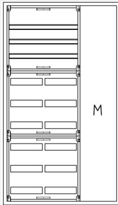
AVK3-9-230-M1-PAutomatenverteiler, AVK, BxHxT = 800x1400x230 Schutzklasse II, IP54, RAL 7035, AufputzBestehend aus:Gehäuse, Einzeltür mit Schwenkhebel für PHZ, Flansche SF45(oben) und SF41 (unten), 1x Geräteträger 2-Feld breit 3/6 mit Feldabdeckungen PS, 1x Montageplatte 1-Feld breit
