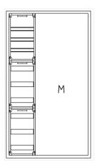
AVK3-9-210-M2Automatenverteiler, AVK, BxHxT = 800x1400x210Schutzklasse II, IP41, RAL 9016, AufputzBestehend aus:Gehäuse, Doppeltür mit Drehriegel, Flansche NF1(oben) und NF2 (unten), 1x Geräteträger 1-Feld breit 3/6 mit Feldabdeckungen PRL, 1x Montageplatte 2-Feld breit
