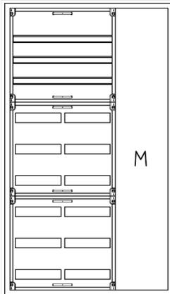
AVK3-9-210-M1-PAutomatenverteiler, AVK, BxHxT = 800x1400x210Schutzklasse II, IP41, RAL 9016, AufputzBestehend aus:Gehäuse, Doppeltür mit Drehriegel, Flansche NF1 (oben) und NF2 (unten), 1x Geräteträger 2-Feld breit 3/6 mit Feldabdeckungen PS, 1x Montageplatte 1-Feld breit
