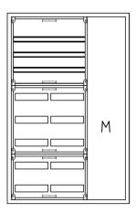
AVK3-8-230-M1-PAutomatenverteiler, AVK, BxHxT = 800x1250x230Schutzklasse II, IP54, RAL 7035, AufputzBestehend aus:Gehäuse, Einzeltür mit Schwenkhebel für PHZ, Flansche SF45(oben) und SF41 (unten), 1x Geräteträger 2-Feld breit 3/5 mit Feldabdeckungen PS, 1x Montageplatte 1-Feld breit
