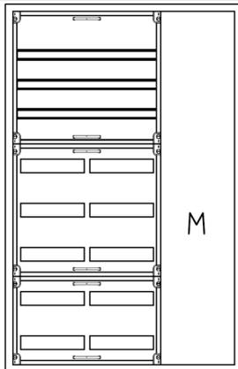
AVK3-8-210-M1-PAutomatenverteiler, AVK, BxHxT = 800x1250x210Schutzklasse II, IP41, RAL 9016, AufputzBestehend aus:Gehäuse, Doppeltür mit Drehriegel, Flansche NF1(oben) und NF2 (unten), 1x Geräteträger 2-Feld breit 3/5 mit Feldabdeckungen PS, 1x Montageplatte 1-Feld breit
