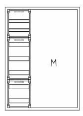
AVK3-7-230-M2Automatenverteiler, AVK, BxHxT = 800x1100x230Schutzklasse II, IP54, RAL 7035, AufputzBestehend aus:Gehäuse, Einzeltür mit Schwenkhebel für PHZ, Flansche SF45(oben) und SF41 (unten), 1x Geräteträger 1-Feld breit 2/5 mit Feldabdeckungen PRL, 1x Montageplatte 2-Feld breit
