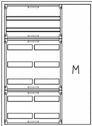
AVK3-7-230-M1 Automatenverteiler, AVK, BxHxT = 800x1100x230 Schutzklasse II, IP54, RAL 7035, Aufputz
